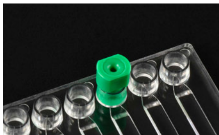
Fig. 578: Mini Luer tube tuck connector for 1/32" OD tubing inserted into a Mini Luer interface
