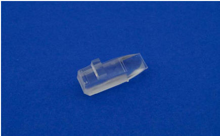
Fig. 869: Miniaturized spectrometer module, ChipGenie Optic TAB project 2013 FE 9021
