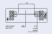
Fig. 64: Channel dimensions droplet generator 0163
